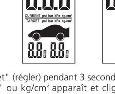
3. La pression du pneu avant ou arrière par défaut s'allume et clignote. Appuyer sur le bouton Up/Down (haut/bas) pour passer du pneu avant au pneu arrière. Appuyer sur "SET" (régler) pour confirmer.
